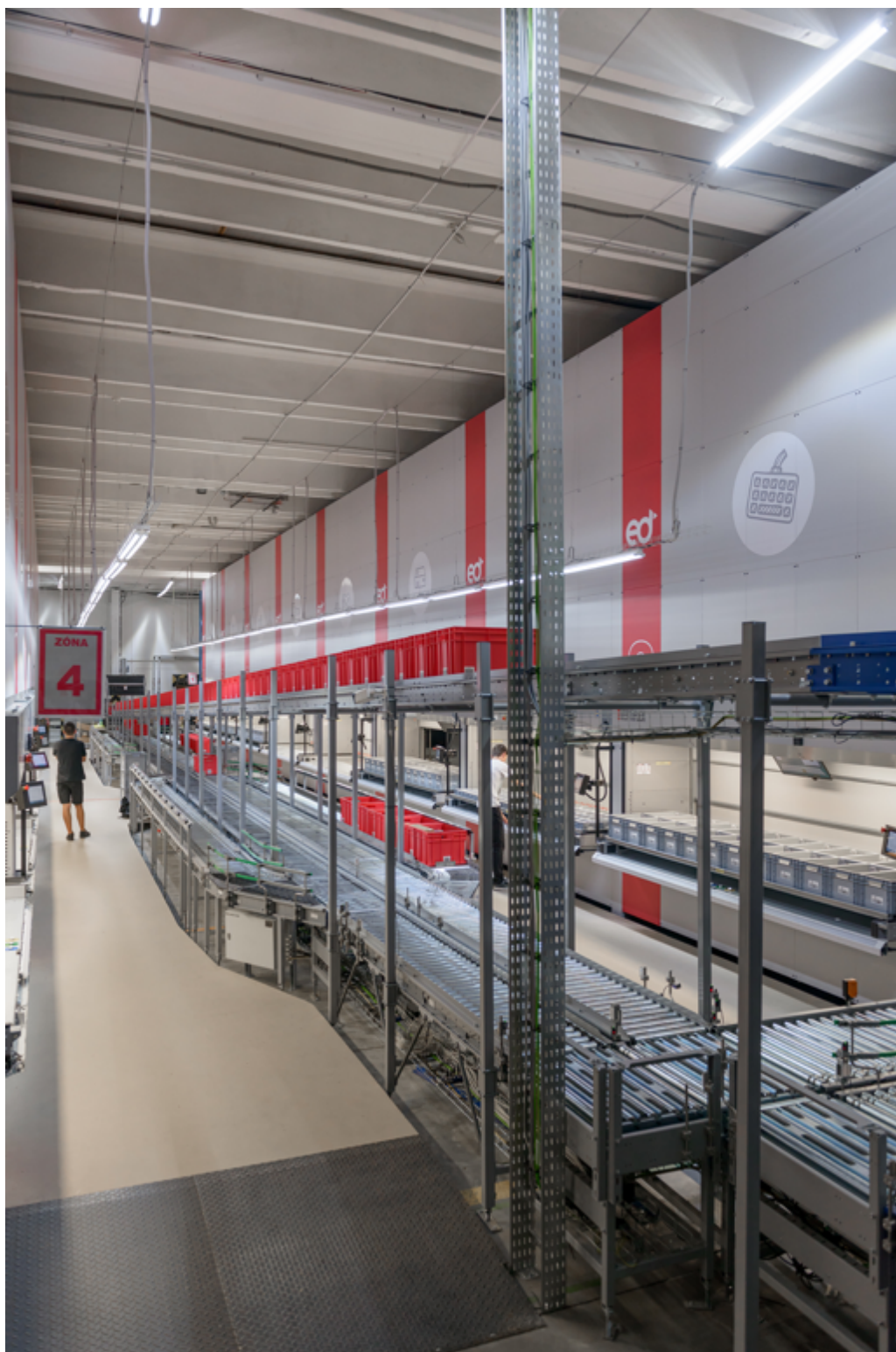
16 vertikálních zakladačů Compact po obou stranách centrálního válečkového dopravníku
