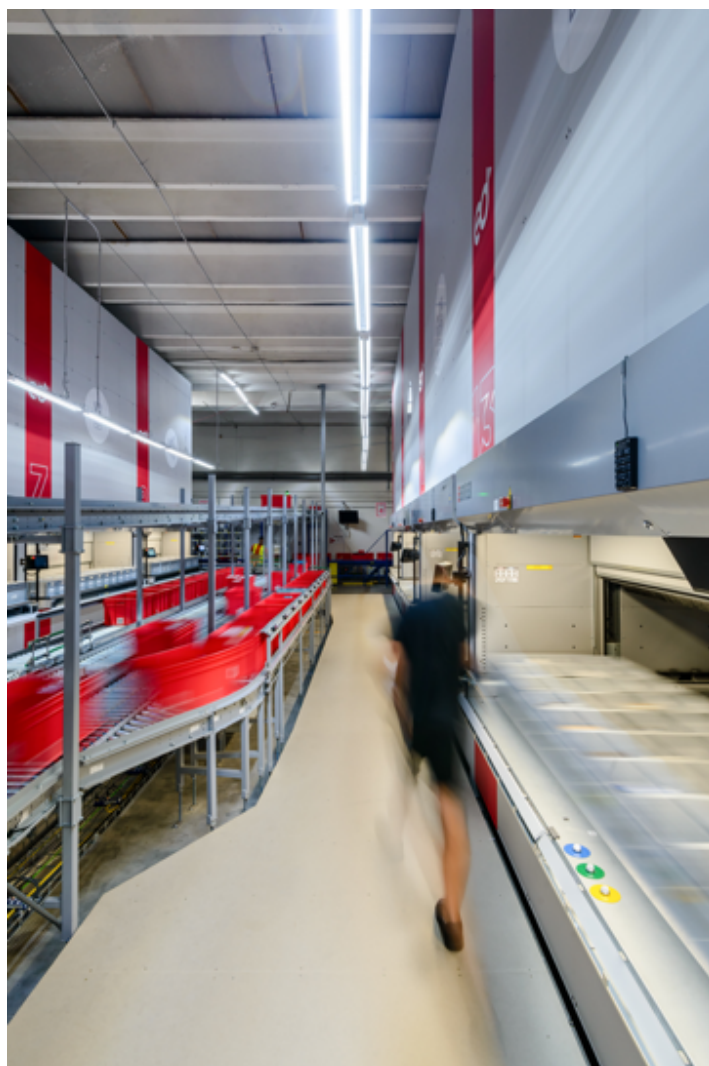
Vychystávací pracoviště napojené na válečkový dopravník a vertikální zakladače Compact
