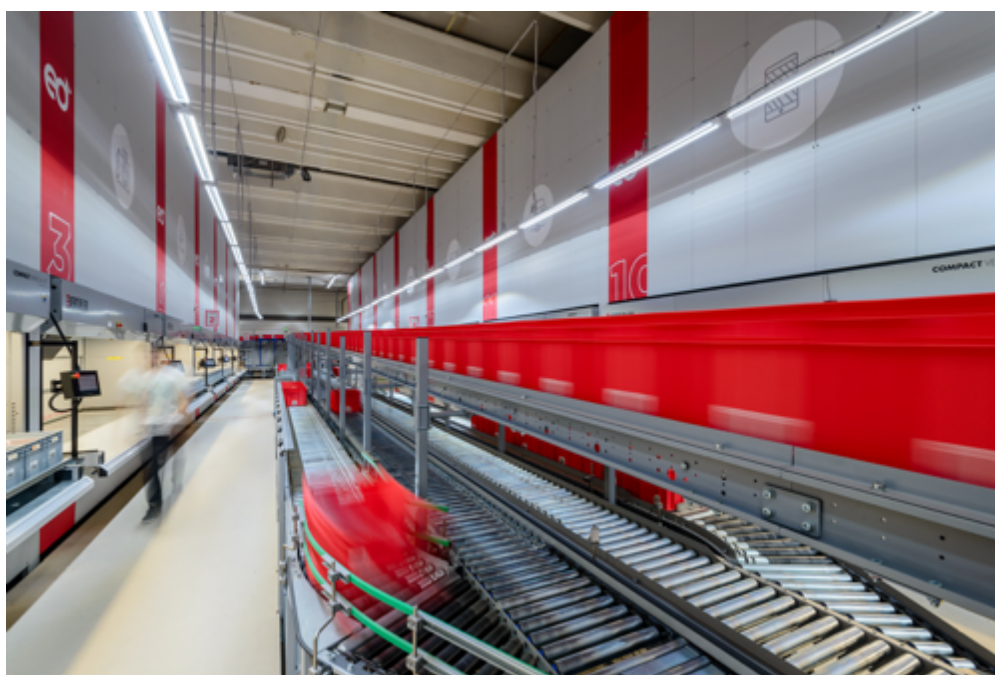
Centrální válečkový dopravník s napojením na vychystávací pracoviště
